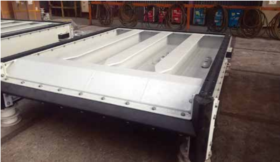
14. Nivelleerschuiif met druppelvormige onderbalk.
