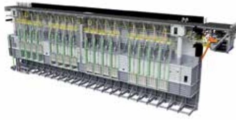
12a. Isometrische dwarsdoorsnede met zestien nivelleerschouwen.
