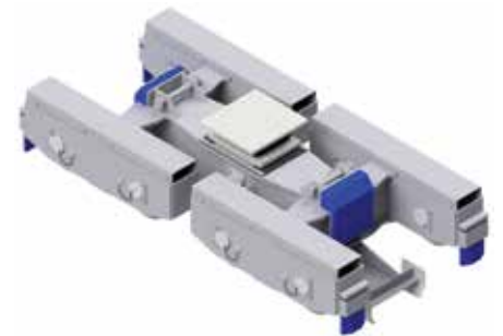
15. Onderwagen en railbaanconstructie.
